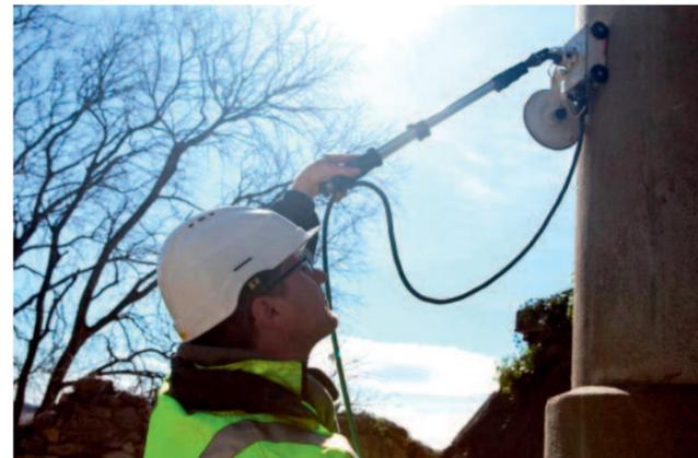
panoplie de plus en plus sophistiquée. La caméra thermique infrarouge, par exemple, permet, grâce aux différences de chaleur, de « voir à travers les murs » et de chercher au bon endroit un désordre de structure ou d'humidité. Comme en médecine, la caméra endoscopique permet d'explorer une cavité inaccessible à l'œil. Très utilisé, le Géo Radar envoie,
